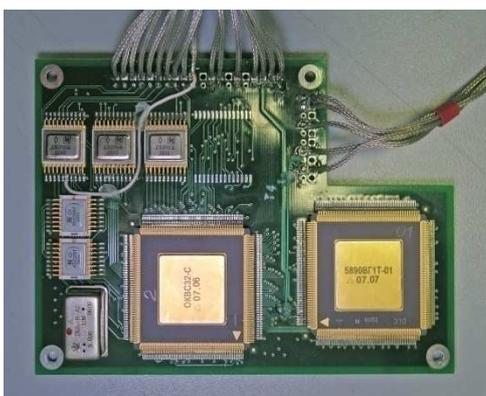
Рис. 4.20. Макет вычислительного модуля для испытаний на спецвоздействия
